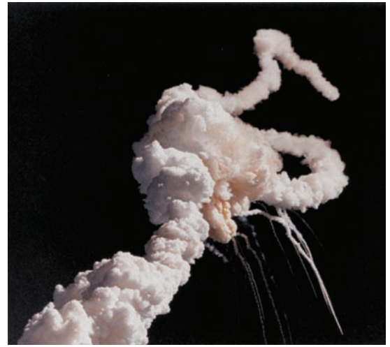
El Challenger explotó a causa del fallo de las juntas tóricas de la nave lo cual ocasionó la fuga del combustible y esto a su vez provocó la explosión.
