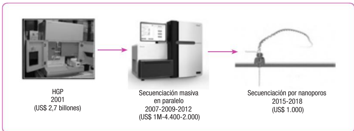
Figura 22.2 Reducción en el costo de la secuenciación hecha por genoma. Se ilustran tres tipos de tecnologías representativas de la evolución de los equipos de secuenciación de ácidos nucleicos y la disminución de los costos de secuenciación. En el panel superior izquierdo el analizador genético, uno de los primeros secuenciadores basado en el método de Sanger o método de terminación de la síntesis de ADN, con los que se realizó el primer borrador del genoma humano. El panel del centro ilustra uno de los equipos de la siguiente generación, que realiza la secuenciación del ADN en paralelo, con un alto rendimiento y que logró bajar los costos de manera significativa. En el panel derecho se ilustra la tecnología de secuenciación de ácidos nucleicos usando la tecnología de nanoporos.
