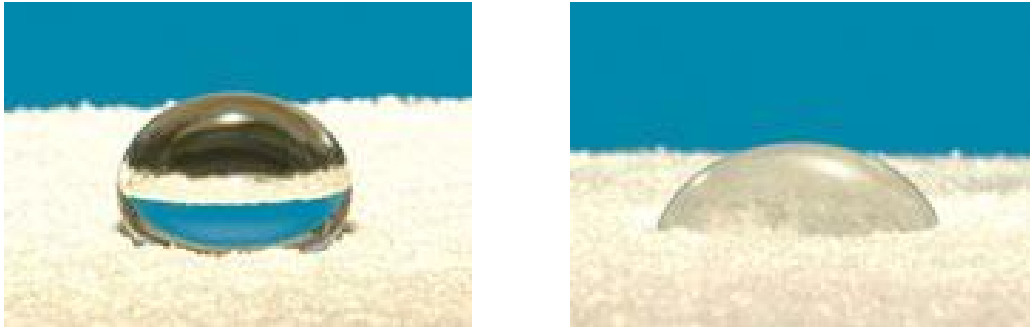
Fig. 11: Formación de gota de Ketac Molar y Ketac Molar Easymix: (1) Polvo con líquido convencional; (2) polvo con líquido Ketac Molar Easymix.
