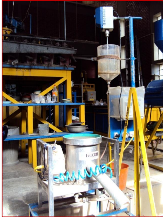
Figura 3.4 Concentrador centrífugo FALCON Gentileza: Laboratorio-Depto. Metalurgia-FNI-UTO, 2010 Oruro-Bolivia
