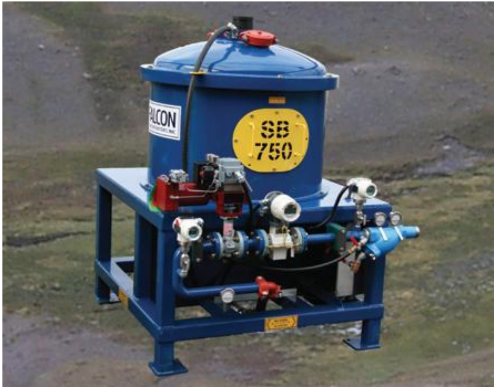
Equipo centrífugo Falcon SB-750 Capacidad: 5-45 TPH
