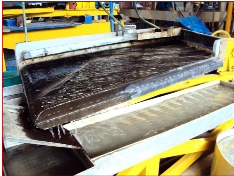
Figura 3.3 Mesa de sacudimientos o vibrante Gentileza; Laboratorio-Depto. Metalurgia-FNI-UTO, 2010 Oruro-Bolivia
