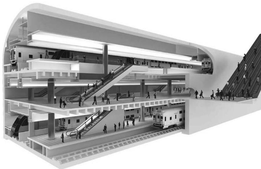
**FIGURA 14.1** Diseño de la plataforma del tren subterráneo de la estación de Penn para el proyecto ARC
