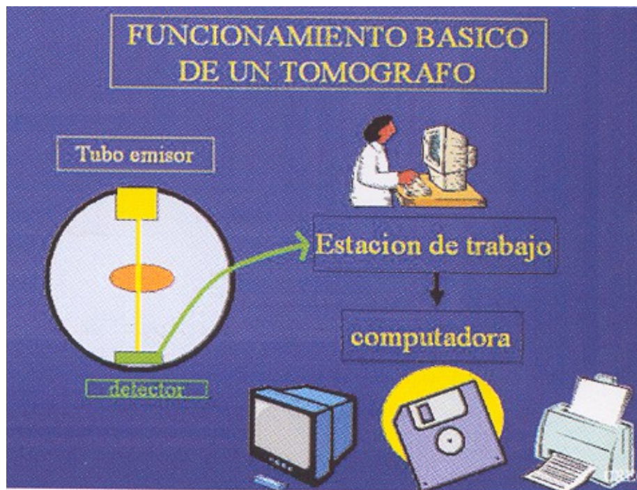
Fig 1. Funcionamiento básico de un tomógrafo, desde el tubo emisor al detector, a la estación de trabajo, y a la computadora.
